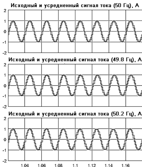
Рис. 2. Результаты применения алгоритма усреднения измеряемого сигнала тока при разных частотах питающей сети
