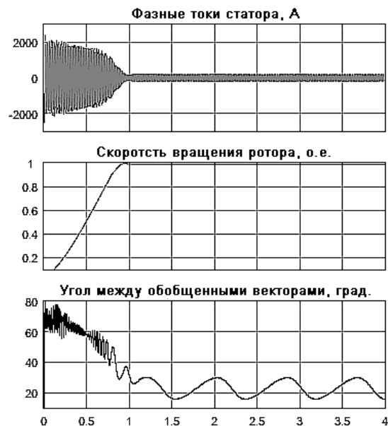
Рис. 4. Графики изменения токов статора, скорости вращения ротора и угла между обобщенным вектором тока статора и обобщенным вектором питающего напряжения при обрыве одного стержня
