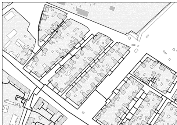
Рис. 2. Пример несоответствия структуры газовой сети города схеме квартального деления:
