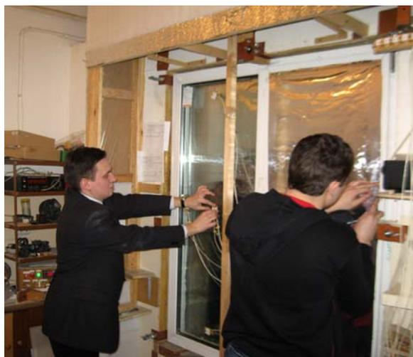
Рис. 4. Установка датчиков на испытываемый образец в климатической камере
