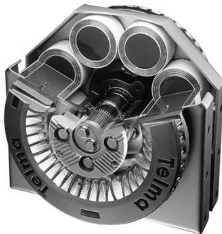
Рис. 1. Электромагнитный ретардер фирмы Telma в разрезе
