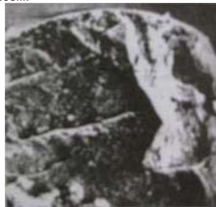
Рис. 2. Фотография ступенек скола на поверхности излома режущей пластины, изготовленной из BOK-200+TiN (увеличение 390)
