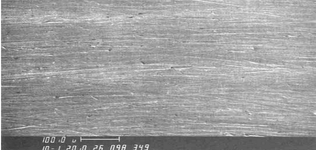
Рис. 1. Микрофотография (x100) поверхности отверстия после обработки в стали 45
