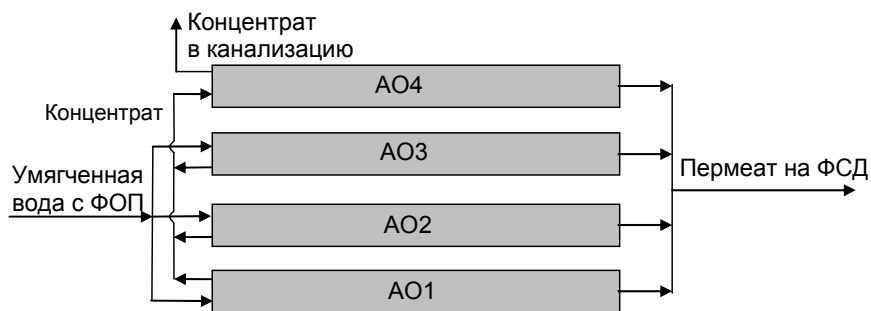
Рис. 5. Технологическая схема обработки воды на УОО №1,2: АО1–АО4 – корпуса установки
