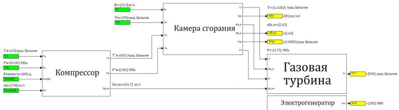
Рис. 1. Обобщенная структурная схема имитационной модели ГТУ в SimInTech
