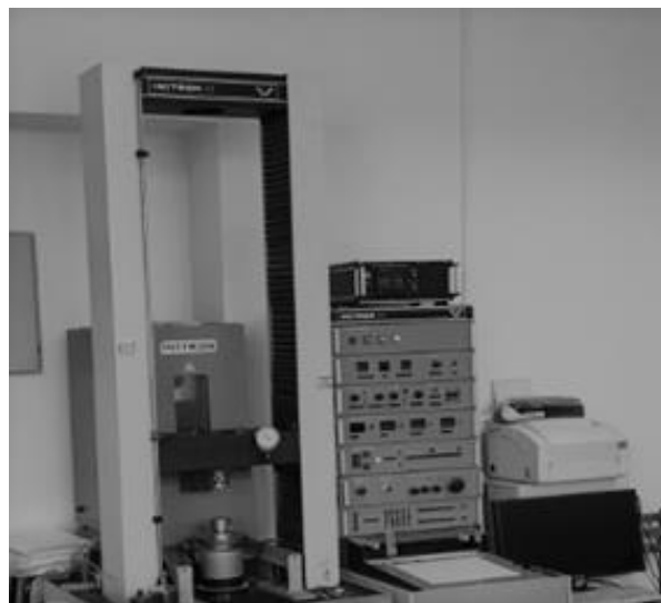
Рис. 4. Лабораторная установка Instron1121 для формирования брикета
