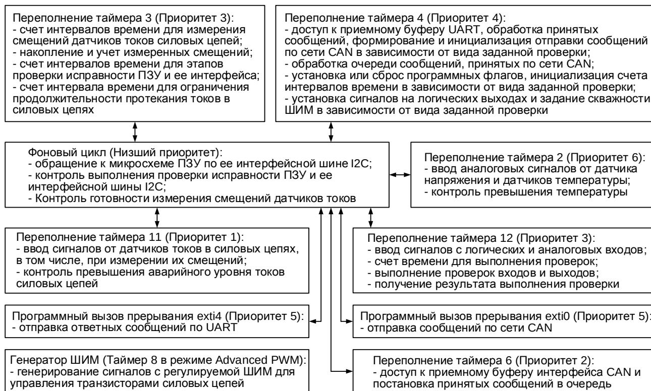
Рис. 2. Блок-схема программного обеспечения электронного блока электропривода в режиме проверки
