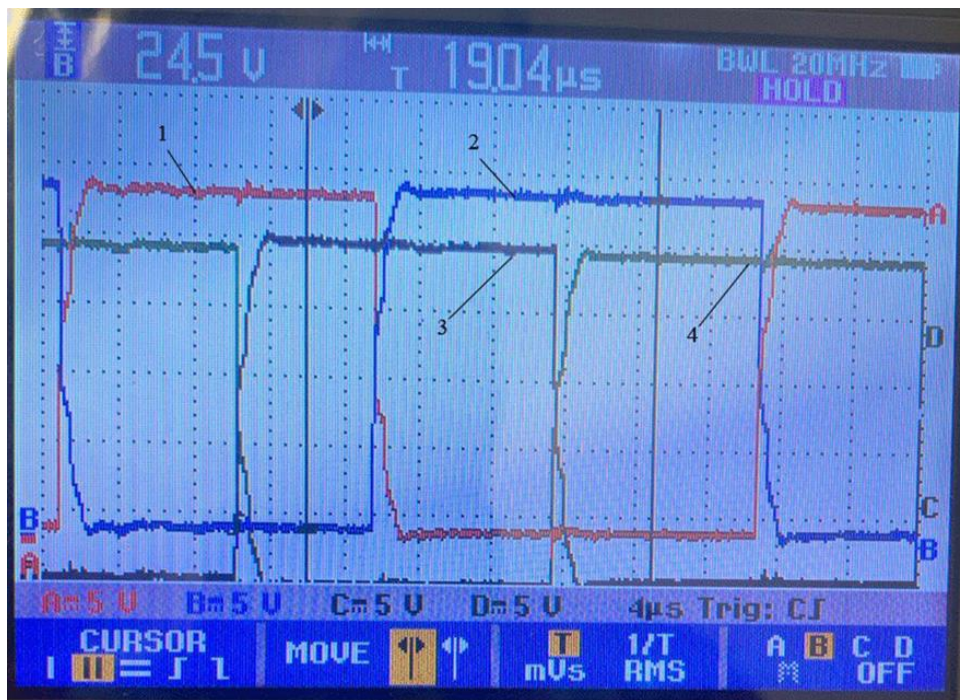
Рис. 5. Сигнал энкодера на карте частотного преобразователя: график 1 – канал А энкодера; график 3 – канал В энкодера; график 2 – канал А' инверсный к каналу А; график 4 – канал В' инверсный к каналу В
