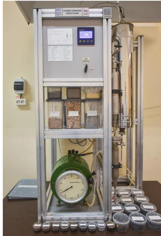
Рис. 3. Установка газификации твердых отходов
