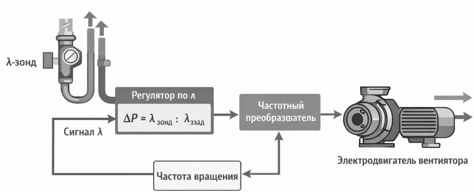
Рис. 2. Структурная схема алгоритма управления дутьевым вентилятором с \lambda -регулированием
