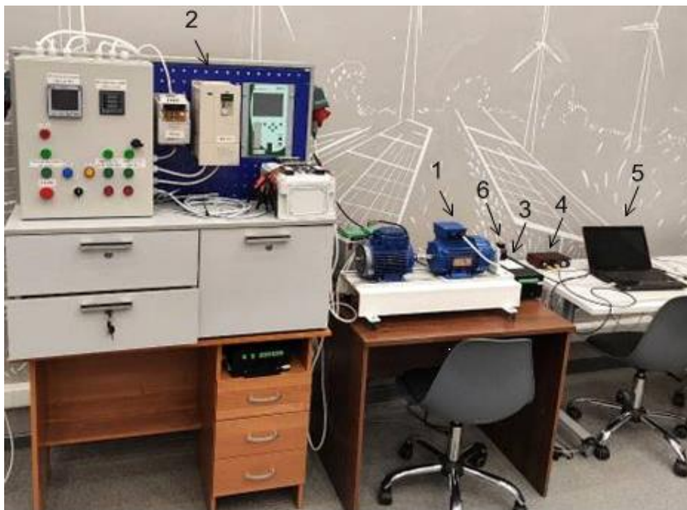
Рис. 1. Внешний вид экспериментального стенда: 1 – АЭД типа АИР71А6; 2 – ПЧ типа Веспер Е4-8400-010Н; 3 – ENMU; 4 – медиаконвертер; 5 – ноутбук; 6 – инкрементальный энкодер типа ЛИР158Б
