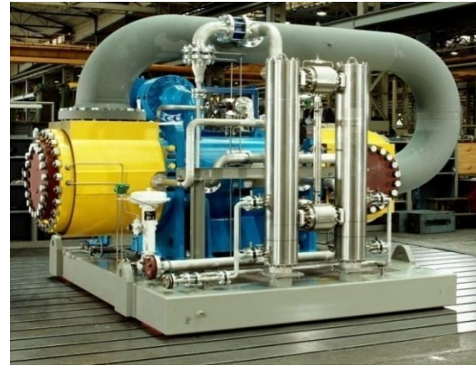
Рис. 1. Общий вид современных герметичных мотор-компрессорных технологических установок для КС МГ
