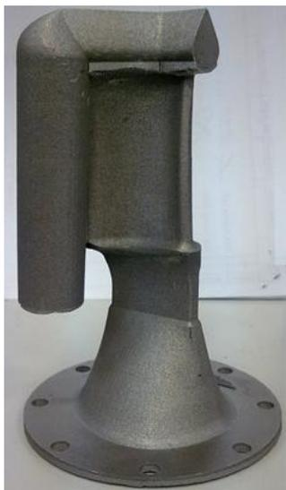
Рис. 3. Фотография модели лопатки для испытания в жидкометаллическом термостате
