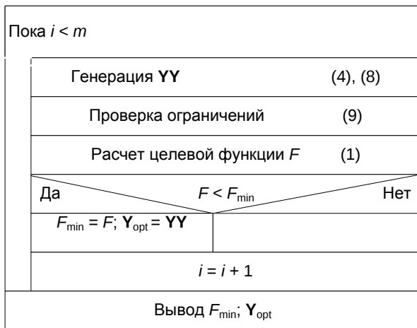
Рис. 4. Алгоритм численного метода решения задачи регуляризации с учетом допустимых значений теплотехнических параметров
