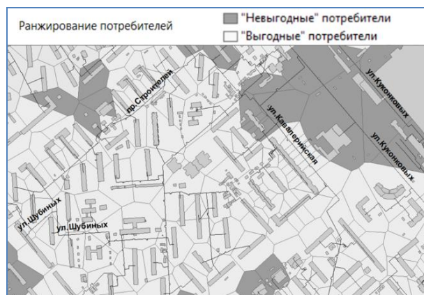
Рис. 2. Фрагмент карты классификации территории города по распределению затрат на потери в тепловой сети
