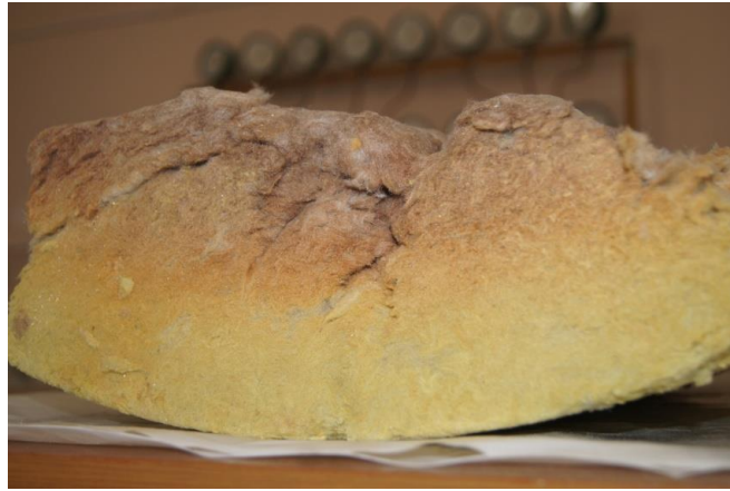
Рис. 1. Образец теплоизоляционного материала с температурной деструкцией
