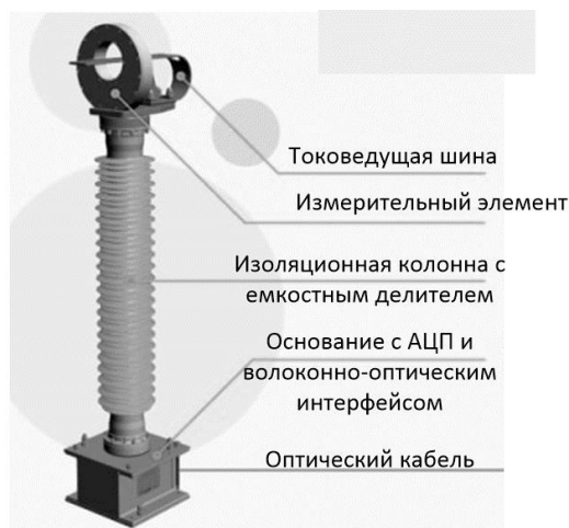
Рис. 2. Внешний вид и устройство оптического измерительного трансформатора (АЦП – аналогово-цифровой преобразователь)
