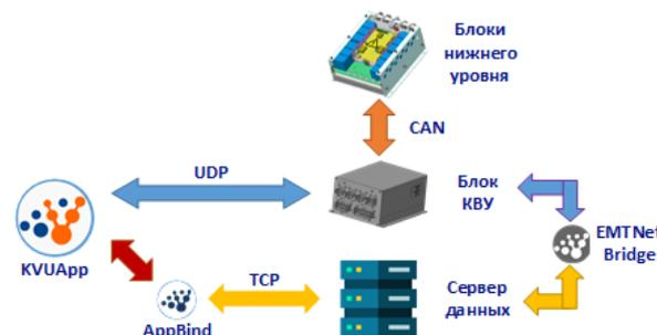
Рис. 4. Схема подключения KVUApp к блокам КТЭО
