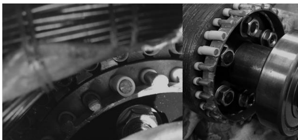
Рис. 7. Проведение эксперимента с обрывом стержня АДКР 3 кВт на экспериментальном роторе
