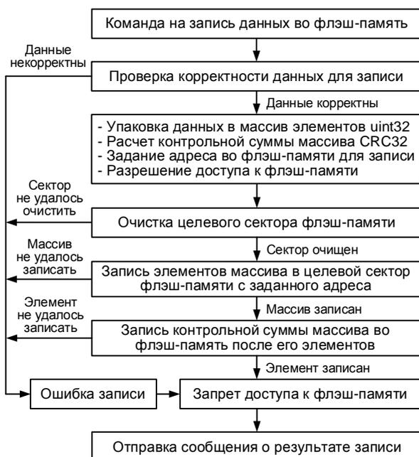
Рис. 8. Блок-схема записи данных во флэш-память
