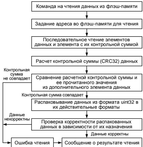
Рис. 9. Блок-схема чтения данных из флэш-памяти
