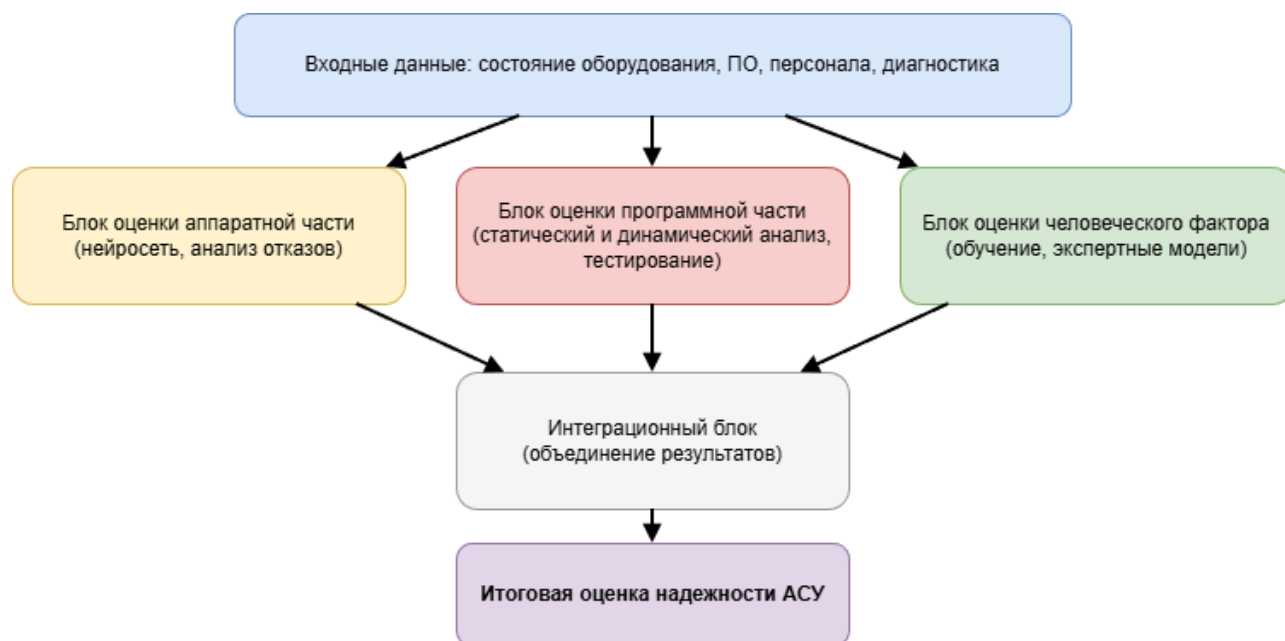
Рис. 2. Структура нейросетевого блока оценки надежности подсистемы АСУП
