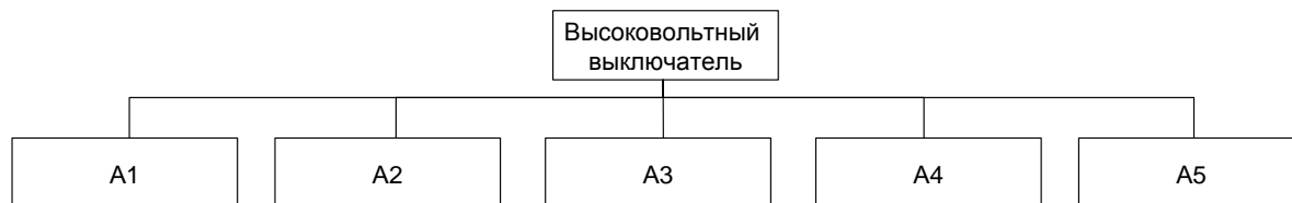
Рис. 3. Первый и второй уровни иерархии: A1 – страна производитель; A2 – срок гарантийного обслуживания; A3 – цена; A4 – характеристика производителя; A5 – тип дугогасящей среды
