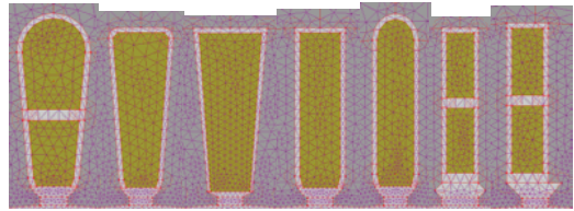
Рис. 11. Варианты пазов для однослойных и двухслойных обмоток статора с учетом изоляции и тока в пазу
