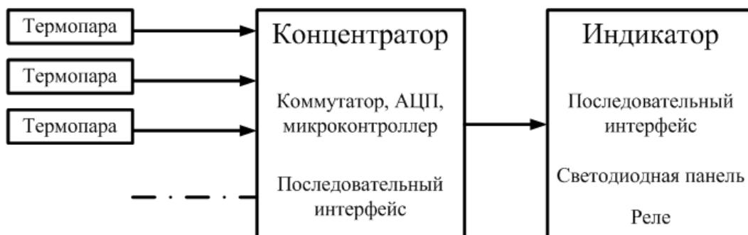
Рис. 6. Структурная схема многоканального монитора с одним концентратором
