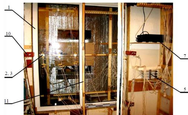
Рис. 3. Схема СИСТОК-IV на базе ИТ-2-96: 1 – оконный блок; 2 – спай термопары на поверхности материала; 3 – тепломер; 4 – спай термопары для измерения температуры воздуха в отделениях; 5 – устройство компенсации УК-4; 6 – соединительный кабель; 7 – ИТ-2-96; 8 – ЭВМ; 9 – принтер; 10 – планки крепления окна; 11 – передвижная планка для размещения термопар
