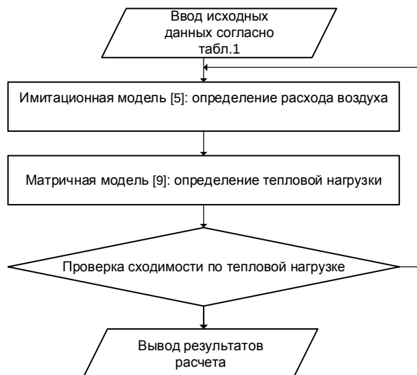
Рис. 1. Алгоритм расчета башенной градирни в рамках комбинированной модели
