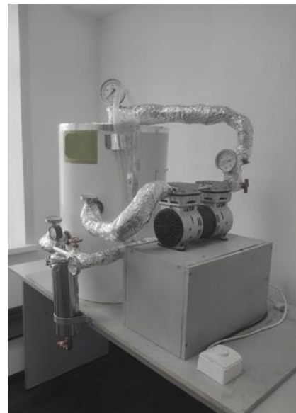
Рис. 3. Принципиальная схема (а) и внешний вид (б) экспериментальной установки: 1 – нагнетательное устройство; 2 – барботажное устройство; 3 – испарительная камера; 4 – компрессор; 5 – нагревательный элемент; 6 – сепаратор; 7, 8 – регулирующие клапаны; 9 – ТЭН
