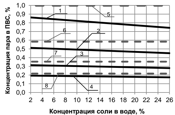
Рис. 6. Зависимости концентрации пара в ПВС от концентрации солей в исходной опресняемой воде и рассоле: 1 – концентрация пара в ПВС при температуре морской воды в зоне барботаж 100 °С; 2 – 90 °С; 3 – 80 °С; 4 – 70 °С; 5 – концентрация пара в ПВС при температуре дистиллированной воды 100 °С; 6 – 90 °С; 7 – 80 °С; 8 – 70 °С
