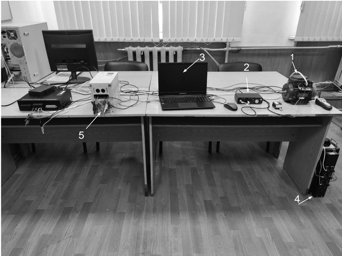
Рис. 1. Лабораторный стенд: 1 – АД типа АИР71А6; 2 – АЦП (Focusrite Scarlett 2i2); 3 – ноутбук; 4 – регулировочный автотрансформатор; 5 – преобразователь частоты
