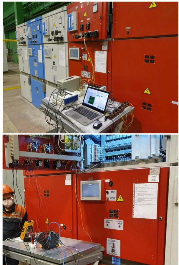
Рис. 3. Фотографии измерительного комплекса, применяемого при исследованиях на действующем оборудовании ЧерМК.
