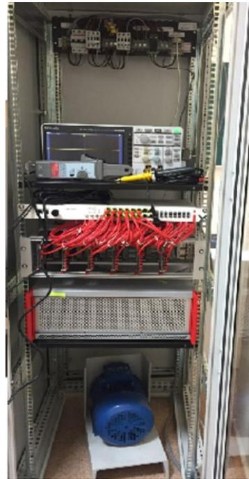
Рис. 7. Фотография специализированной лабораторной установки для исследования ЭМС ПЧ-АВ с питающей сетью
