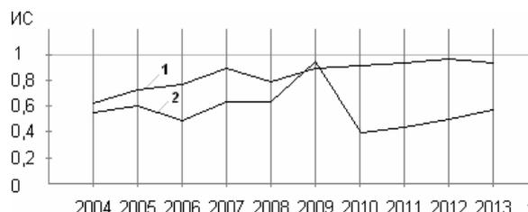
Рис. 3. Изменение ИС двух трансформаторов 1 и 2 с ресурсом использования, близким к двукратному (второй трансформатор прошел капитальный ремонт в 2009 г.)
