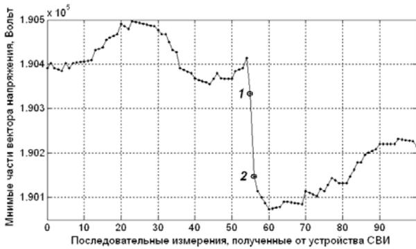
Рис. 2. Иллюстрация скачкообразного изменения сигнала, в данном случае – мнимой части вектора напряжения фазы А в начале линии 345 кВ (Висконсин, США)
